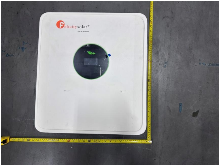
Battery: FLA24171-EU, 25.6V, 171Ah, 4.4kWh
